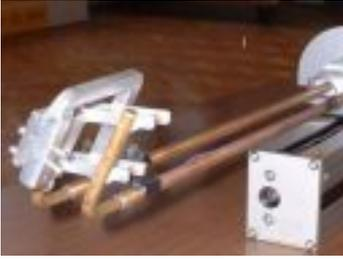
*Апстракт:* Експериментално истраживање турбулентног вихорног струјања у цевима захтева прецизно позиционирање сонди са загрејаним влакнима. Приказана је варијанта механизма за мерење са две V сонде са загрејаним влакнима. Механизмом се остварује дужинско и угловно позиционирање сонди. Неопходно је остварити и одговарајуће аксијално растојање између сонди због мерења корелација брзина.
