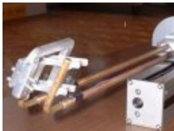
*Apstrakt:* Eskperimentalno istraživanje turbulentnog vihornog strujanja u cevima zahteva precizno pozicioniranje sondi sa zagrejanim vlaknima. Prikazana je varijanta mehanizma za merenje sa dve V sonde sa zagrejanim vlaknima. Mehanizmom se ostvaruje dužinsko i uglovno pozicioniranje sondi. Neophodno je ostvariti i odgovarajuće aksijalno rastojanje između sondi zbog merenja korelacija brzina.
